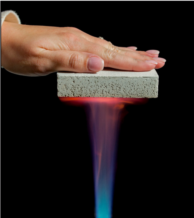
خرسانة براتلي بيرل مقاومة للحريق ولها قيمة توصيل حراري نموذجية متدنية : كلفن = 0,13 واط لكل متر مكعب
