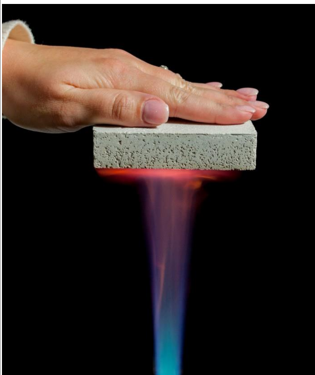
خرسانة تودو بيرلايت مقاومة للحريق ولها قيمة توصيل حراري نموذجية متدنية : كلفن = 0,13 واط لكل متر مكعب
